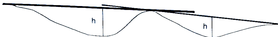
Slika 1: Postavitev merilne letve za določitev odstopanja posameznih neravnin h na vozni površini
